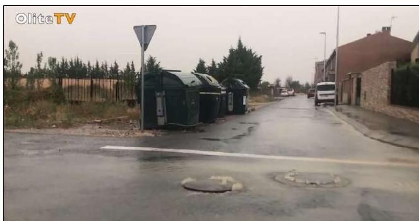
**Ilustración 38.** Imagen del inicio de la inundación en un punto bajo de Olite, a través del retorno del agua por la red de alcantarillado, añadiéndose el riesgo de que se desplacen las tapas de su lugar.
